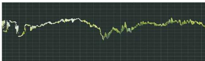
写真測量の特徴として、**植生地での使用に不向き**です。写真に写った表面のみが再現される為、土工現場等に適しています。
