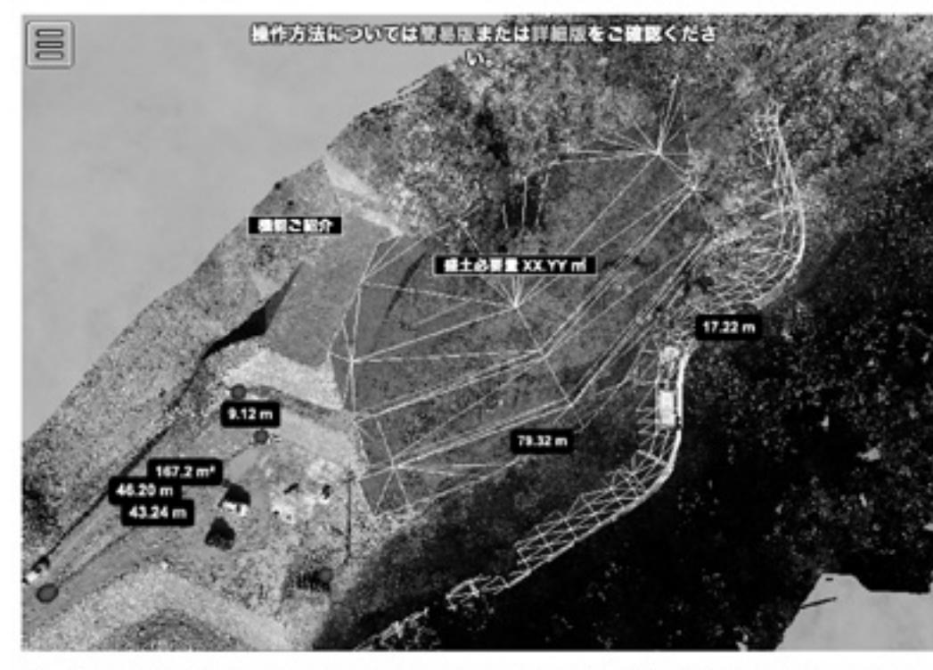
ビューアはGitHub上で開発・公開されているツール「Potree」をベースに使用しています。本来はデータの重さから表示に適応するPCのスペックを要求されますが、本ツールにてデータを制御しつつ視認性を向上し、スムーズな表示を可能としました。弊社では独自に3Dモデルを組み合わせるシステムを定型化し、現況と計画の比較に使用しております。
